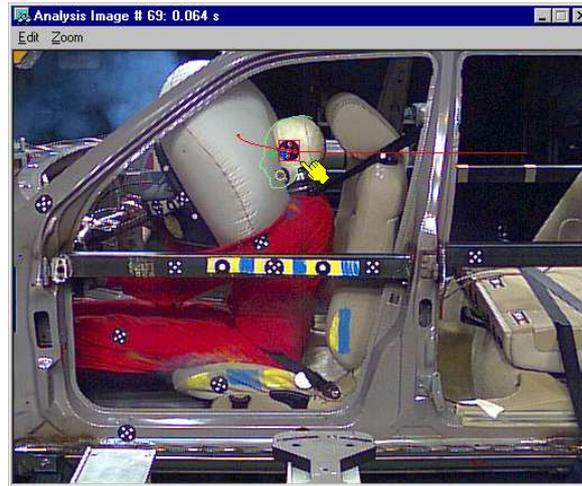
Das Modul MovXact ermöglicht die präzise 2D-Auswertung von Bildsequenzen mit den Methoden der Bildmesstechnik. Neben der robusten automatischen Markenverfolgung wird eine anwendungsspezifische Kalibrierung und Aufbereitung der Messergebnisse unterstützt. Messkurven und einzelne Messwerte werden passgenau zu den Bilddaten oder in Diagrammen visualisiert, numerisch angezeigt und in standardisierte Dateiformate ausgegeben.
